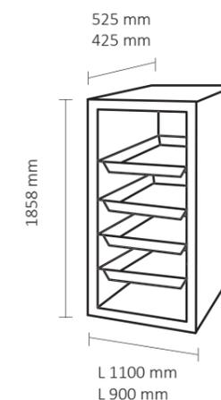
**!** L'armoire doit contenir exclusivement des produits phytosanitaires. En cas de fuite de l'emballage, qui doit être impérativement d'origine, le produit doit être retenu dans un bac de rétention, pouvant accepter au moins 50% du volume total des produits rangés dans ce dernier.
